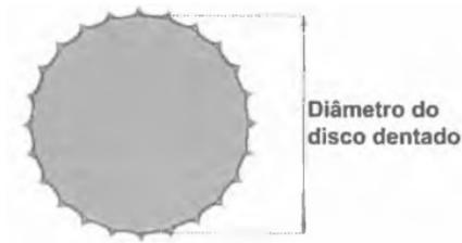
O ciclista já dispõe de uma catraca com 7 cm de diâmetro e pretende incluir uma segunda catraca, de modo que, à medida em que a corrente passe por ela, a bicicleta avance 50% a mais do que avançaria se a corrente passasse pela primeira catraca, a cada volta completa dos pedais.
