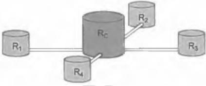
As ligações entre o reservatório central e os auxiliares são feitas por canos cilíndricos com 0,10 m de diâmetro interno e 20 m de comprimento, conectados próximos às bases de cada reservatório. Na conexão de cada um desses canos com o reservatório central há registros que liberam ou interrompem o fluxo de água.
