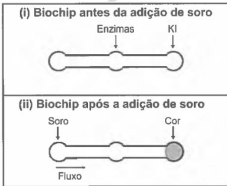
Após a adição de soro sanguíneo, o fluxo desloca-se espontaneamente da esquerda para a direita (ii) promovendo reações sequenciais, conforme as equações 1 e 2. Na primeira, há conversão de glicose do sangue em ácido glucônico, gerando peróxido de hidrogênio:
