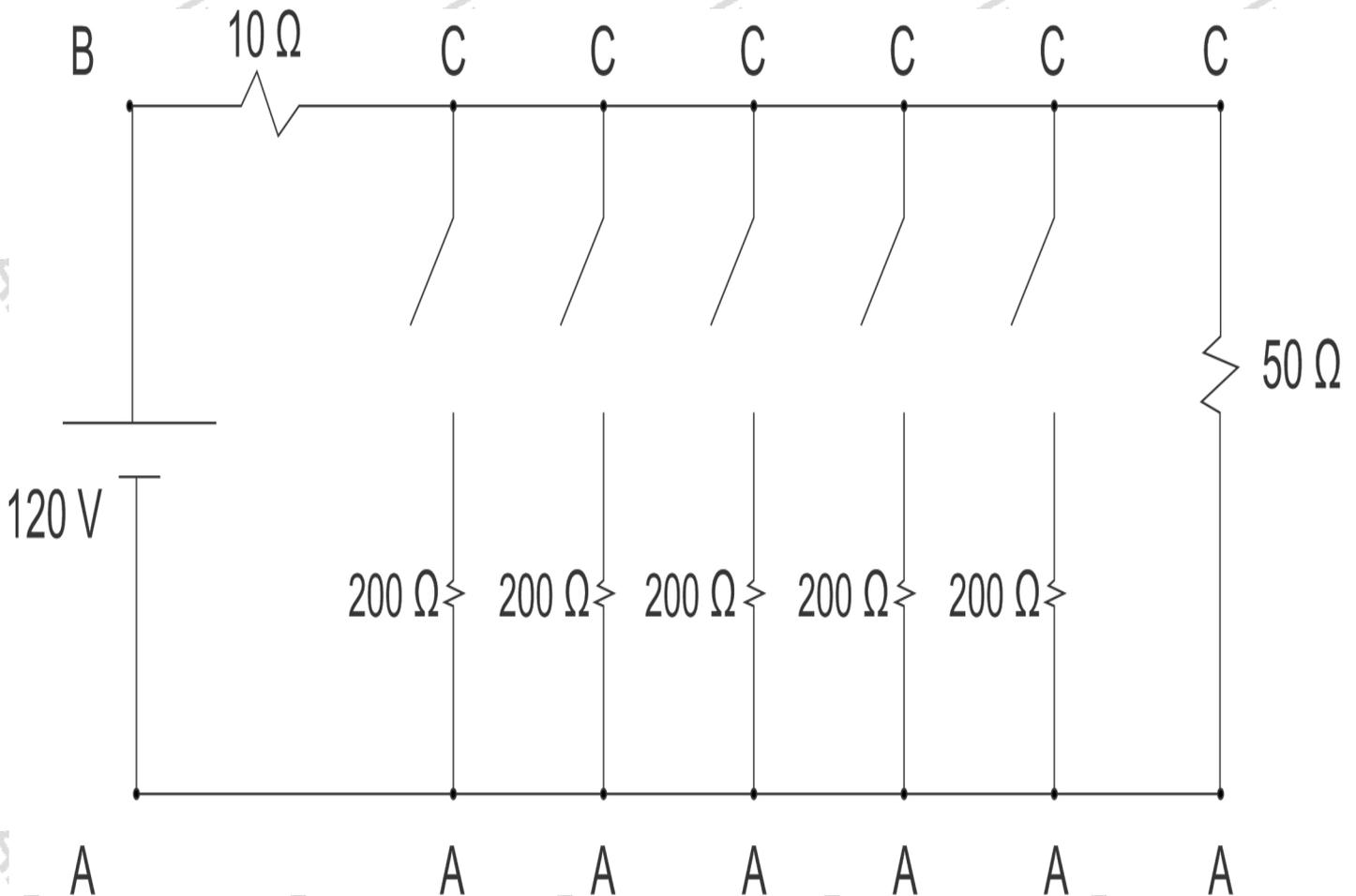
Observa-se que o resistor entre B e C está ligado em série com a associação em paralelo das lâmpadas com a TV.
