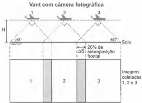
O operador do vante recebe uma encomenda na qual as imagens devem ter uma sobreposição frontal de 20% em um terreno plano. Para realizar a aquisição das imagens, seleciona uma altitude  $H$  fixa de voo de 1 000 m, a uma velocidade constante de  $50 \text{ m s}^{-1}$ . A abertura da câmera fotográfica do vante é de  $90^\circ$ . Considere  $\text{tg}(45^\circ) = 1$ .
